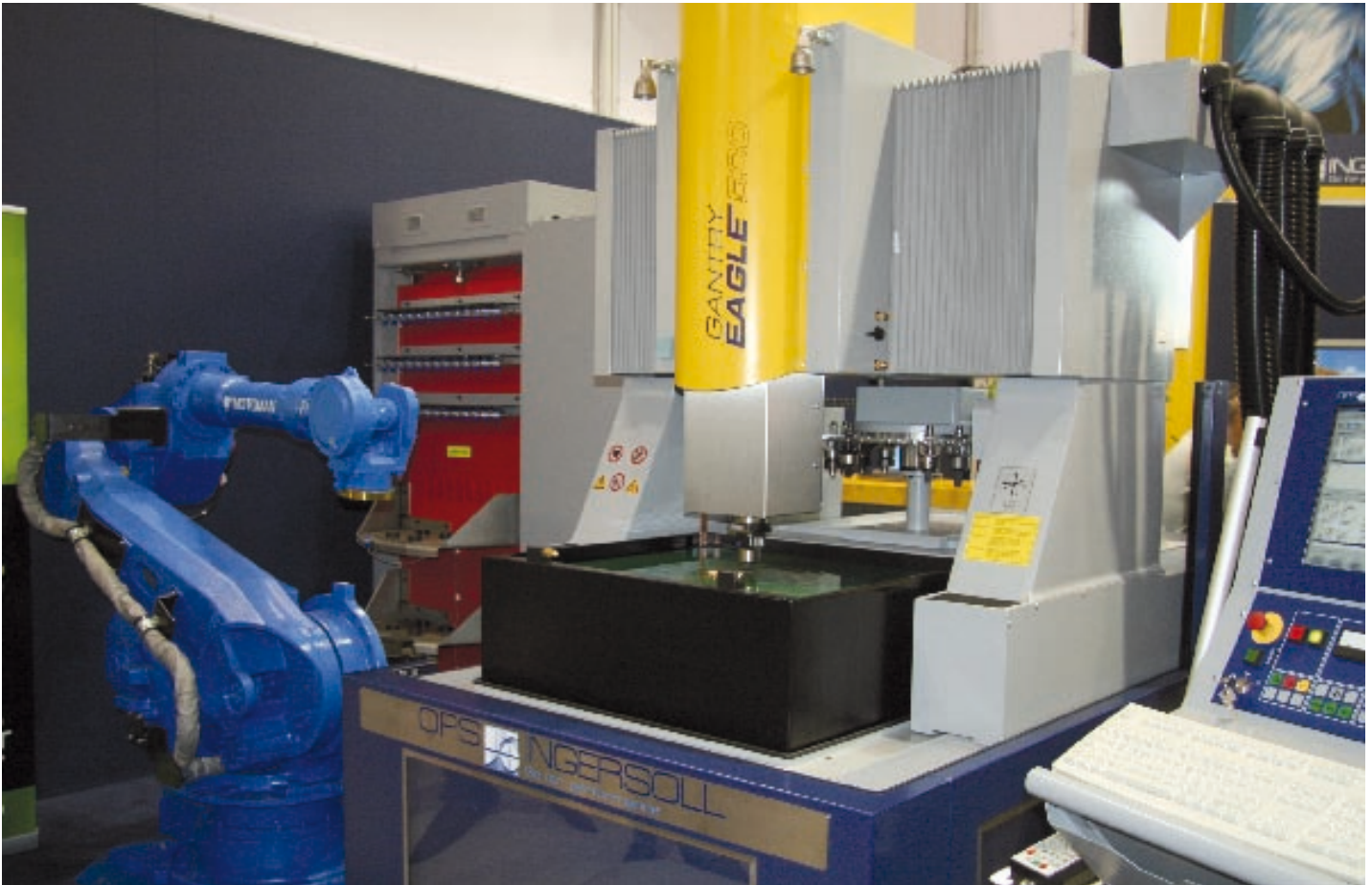
Auf der AMB hatte OPS-Ingersoll den 6-Achs-Roboter mit deren EDM-Maschine Gantry Eagle 500 und dem Mastermagazin verknüpft. Der Clow ist die Trennung von Arbeits- und Mastermagazin, welche trotz Be- und Entladen und sogar punktueller Instandhaltung für ununterbrochene Produktion sorgt.
