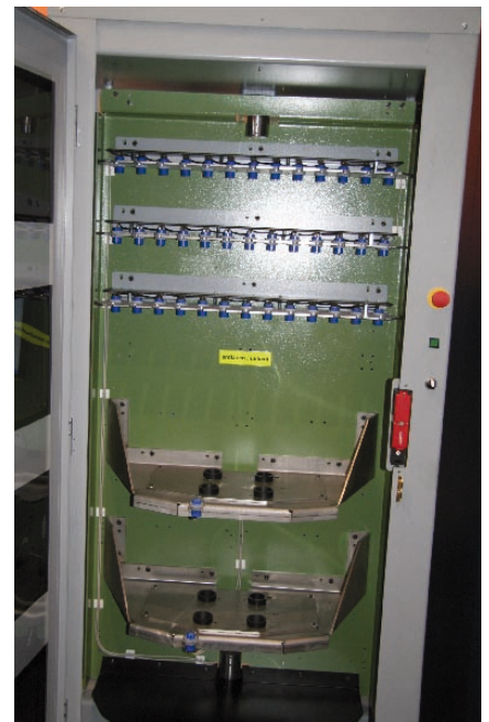
Flexibles Mastermagazin: Die Be- und Entlade-schnittstelle kann kleinere Spannsysteme für Erodier-Elektroden aufnehmen, genauso wie Paletten bis 600 x 400 mm.
